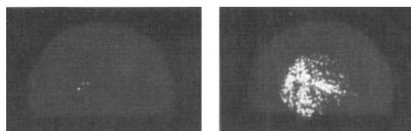
Abb. 20. Autoradiographien von Eisen-dotiertem Silicium nach Neutronenaktivierung [30]. Links: Beginn der Fe-Ausscheidungen; rechts: starke Fe-Ausscheidungen. Abstand der Proben im Siliciumstab: 5 cm.
