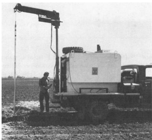
Abb. 19. Ein mobiles Feldlaboratorium (Mobil Research and Development Corp., Dallas) für die Aktivierungsanalyse mit 14 MeV-Neutronen unter Verwendung einer Bohrlochsonde, bestehend aus einer gepulsten 14 MeV-Neutronenquelle, einem Gamma- und einem Neutronendetektor.
